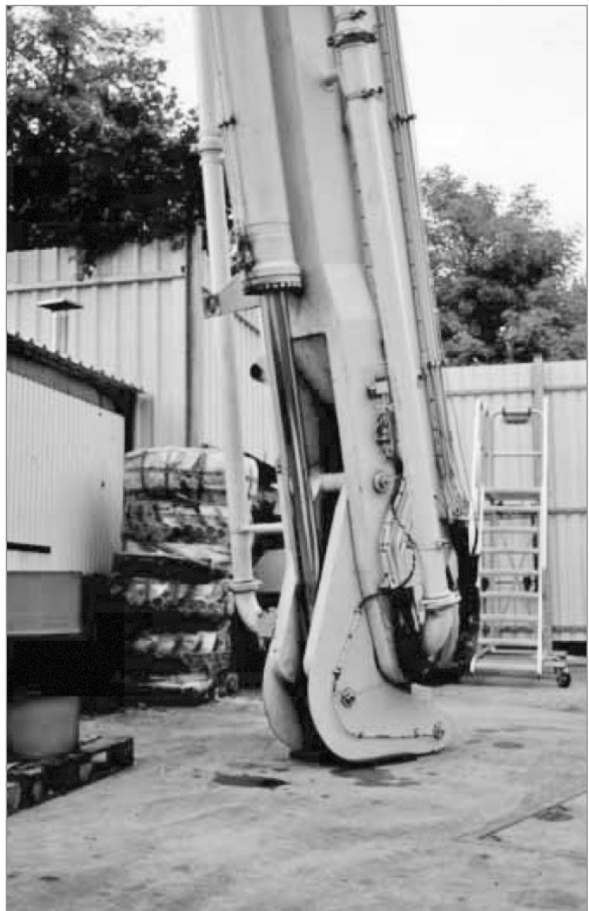
Pescante de una bomba de hormigón, bajado a tierra
